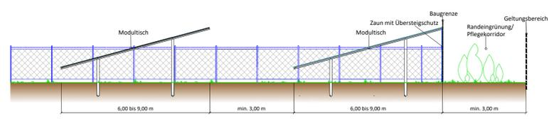
Regelquerschnitt Sondergebiet Photovoltaik
